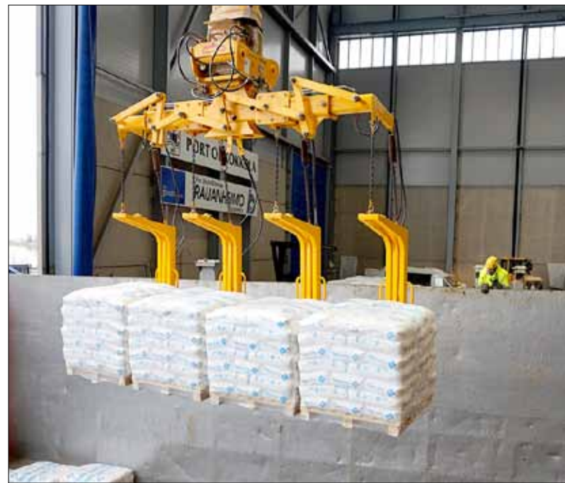
I Kokkola fylles gjødselbåten under tak. Det er en slik kran Yara mener kan håndtere sterk økning i lasting over kai i Glomfjord. Begge bildene: Helge Hamnevoll
