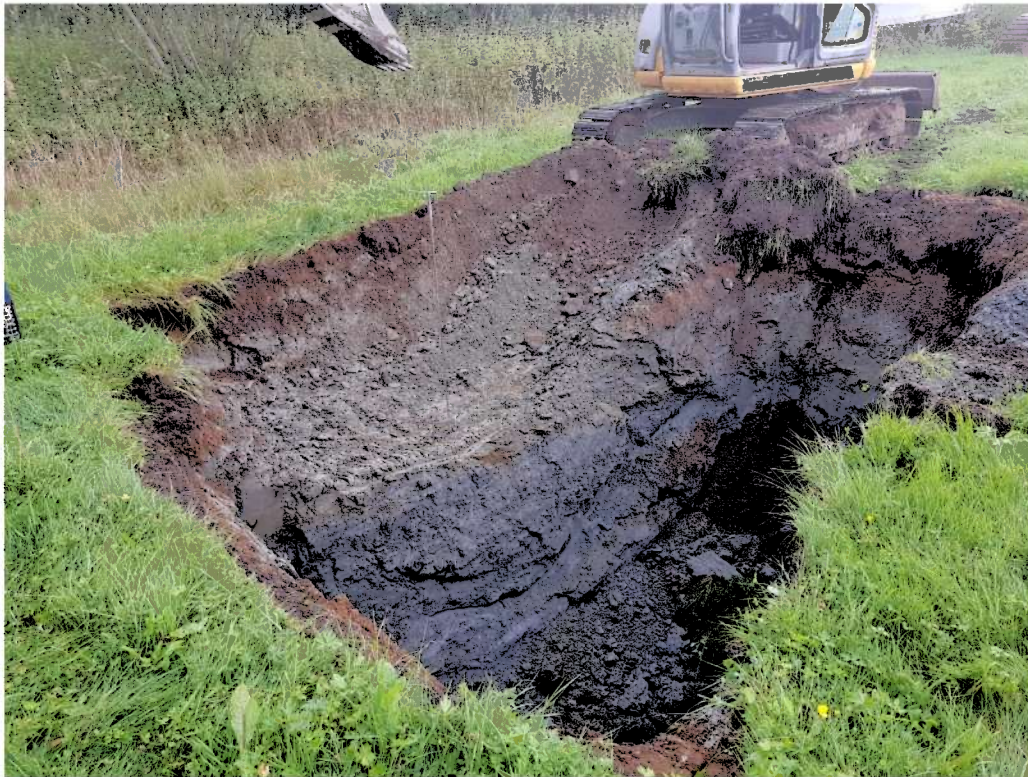
Figur 4: P01, stoppet i fast leire. Vingebor vist i bilde.
