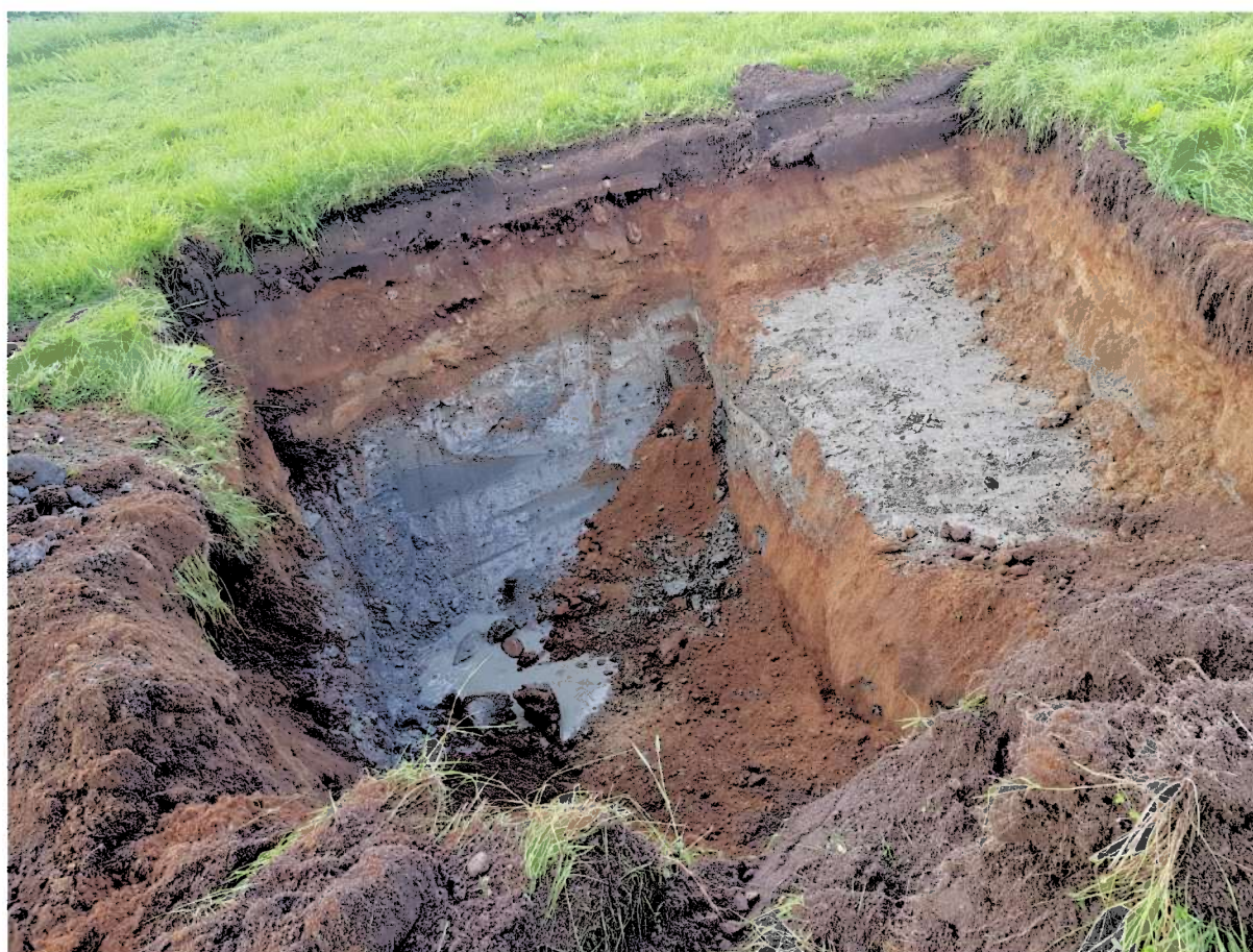
Figur 8: P03. Stoppet i fast leire, bilde viser endelig gravet dybde.
