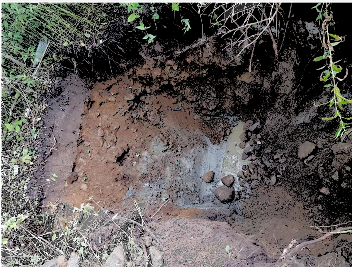
Figur 11: P04. Stoppet i fast leire, bilde viser endelig gravet dybde..
