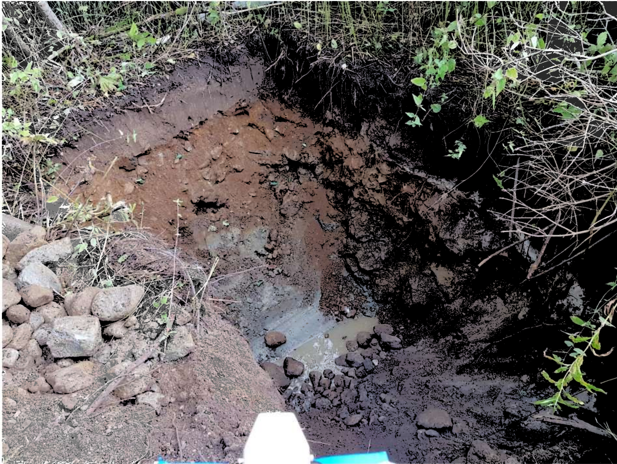
Figur 12: P04. Stoppet i fast leire, bilde viser endelig gravet dybde.
